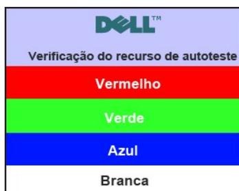
4. Esta caixa também aparece durante a operação normal do sistema se o cabo de vídeo perder a conexão ou for danificado.
