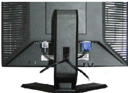
Depois de instalar todos os seus cabos no seu monitor e computador (consulte [Conexão com seu monitor](#) para conexão de cabo), use a fenda de administração de cabo para organizar todos os cabos acima.
