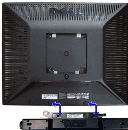
1. Na parte de trás do monitor, fixe o Soundbar alinhando os dois slots com os dois guias ao longo da parte inferior traseira do monitor.
